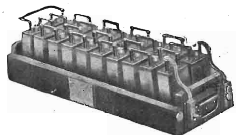
Batteria tipo 20 Qt. - Tensione 40 Volt Capacità 2,3 Amperora alla scarica di 0,05 Ampere
